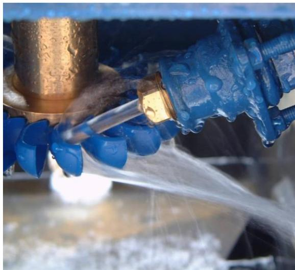
Figura 18: Modelo simplificado de turbina Turgo (Hartvigsen Hydro, 2020)
