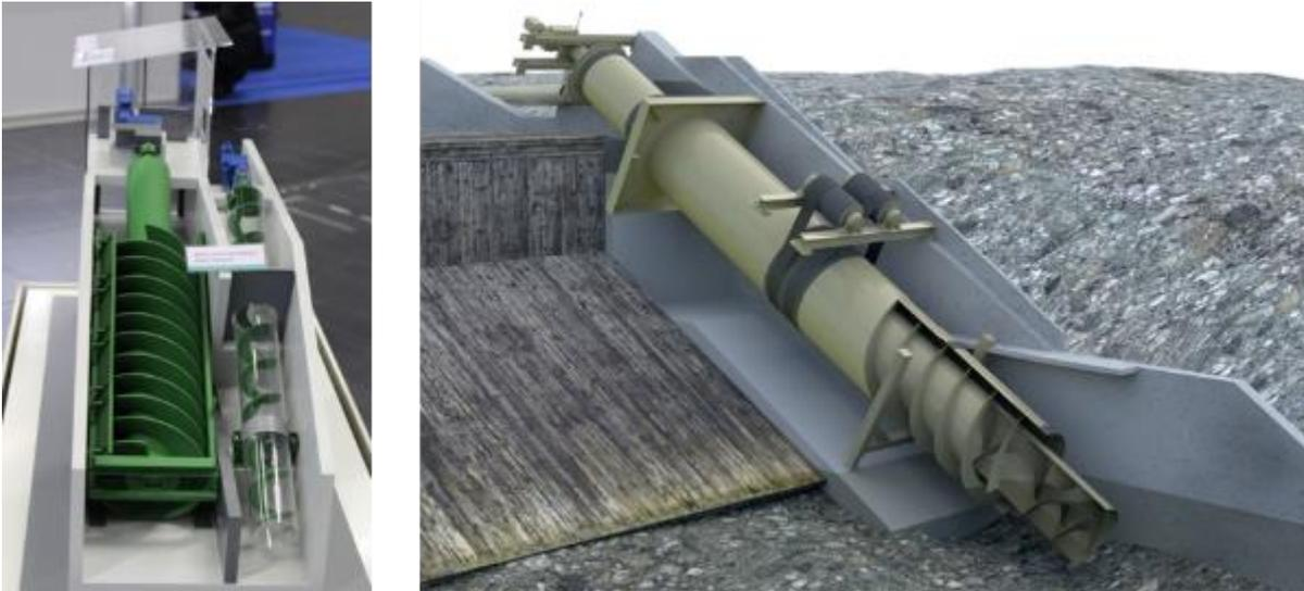
Figura 45: Un tornillo de Arquímedes paralelo colocado por Rehart Power (izquierda) y una vista 3D de la unidad de tornillo coaxial de Hydroconnect (derecha) en la Feria RENEXPO Interhydro en 2017 (Fuente: J. Steller)
