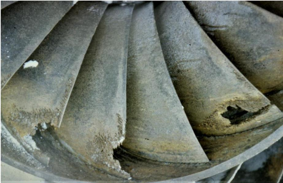
**Figura 13: Amplio daño por cavitación en el lado de succión de un pequeño rotor de turbina Francis (1970s, fuente: archivos IMP PAN)**
