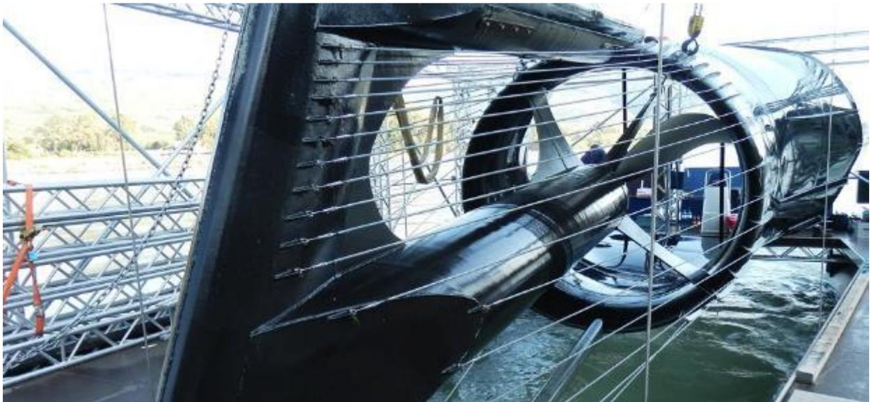
**Figura 41: Unidad hidrocínética 3, proyecto Strom Boje (Fuente: Aqua Libre Energieentwicklungs GmbH)**
