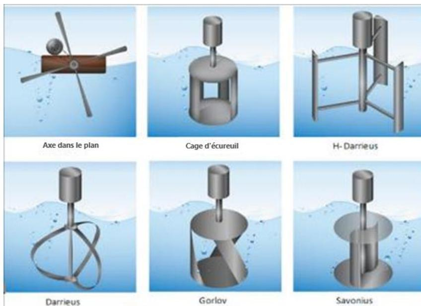
Figure 40: Turbine cinétique à axe vertical (Khan, 2009)
