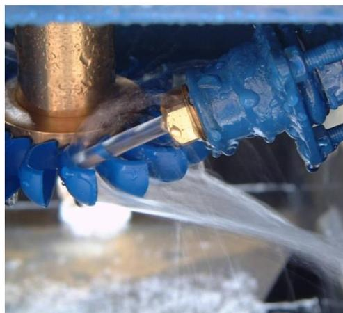
Figure 18: Un modèle de turbine Turgo simplifié (Hartvigsen Hydro, 2020)
