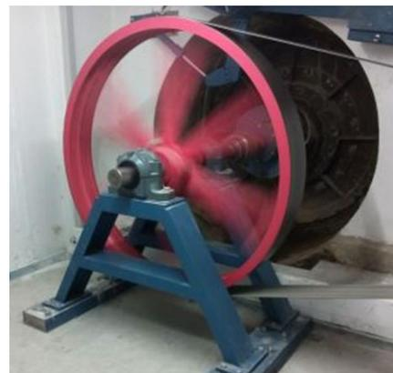
Figure 53: Transmissions à courroie plate dans les micro-installations hydroélectriques (Burger Wasserkraftanlagen, 2020)
