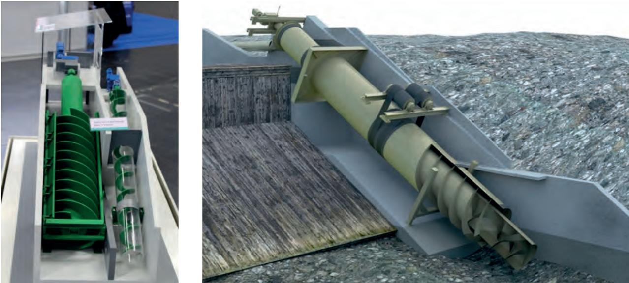
Figure 45: Un jeu de vis d'Archimède parallèle par Rehart Power (à gauche) et une vue 3D de l'unité de vis coaxiale Hydroconnect (à droite) au RENEXPO Interhydro Fair en 2017 (source : J. Steller)
