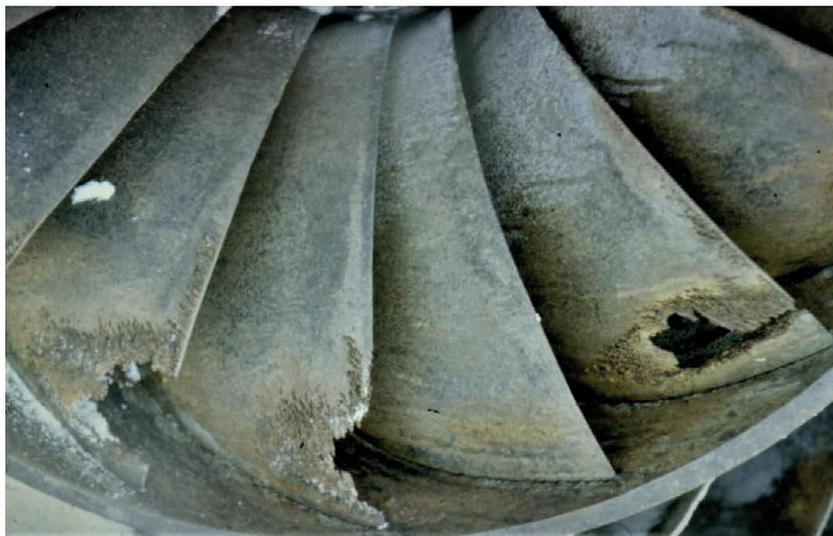
**Figure 13:** Dommages importants dus à la cavitation du côté aspiration d'une petite roue de turbine Francis (Années 1970, source : archives de l'IMP PAN)
