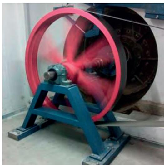
Figura 53: Correas de transmisión planas instaladas en instalaciones de micro centrales hidroeléctricas (Burger Wasserkraftanlagen, 2020)
