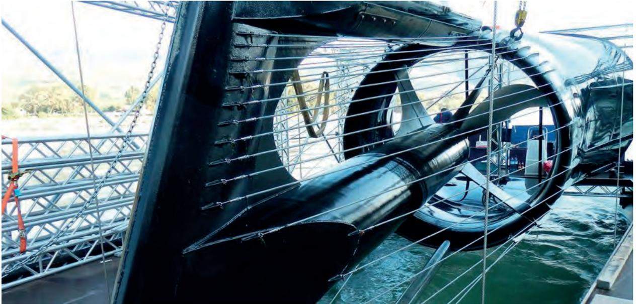
**Figura 41: Unidad hidrocíntrica 3, proyecto Strom Boje (Fuente: Aqua Libre Energieentwicklungs GmbH)**
